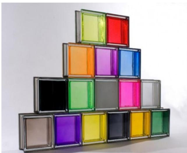
Alguns anos atrás só se via tijolo de vidro transparente liso ou com texturas na medida de 19X19X8, agora contudo encontram-se várias cores e até com LEDs. O tijolo de vidro é fabricado soldando duas peças de vidro a uma temperatura bastante elevada, deixando no seu interior uma câmara de ar que permite um grau de isolamento térmico e acústico bastante grande.
